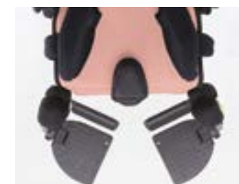
957 Poggiatesta con pedane separate. Regolabili in altezza, inclinazione e abduzione in modo indipendente.
