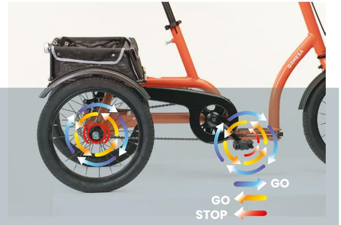
Permette di tenere fermi i pedali mentre la bici è in movimento, la **frenata con contro pedale** e la **retromarcia**.
