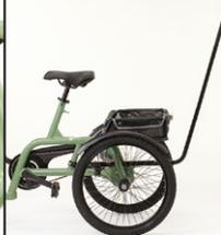
**963** Maniglione STERZANTE, per l'assistente, regolabile in altezza. Non installabile in presenza dei componenti 881 o 882.
